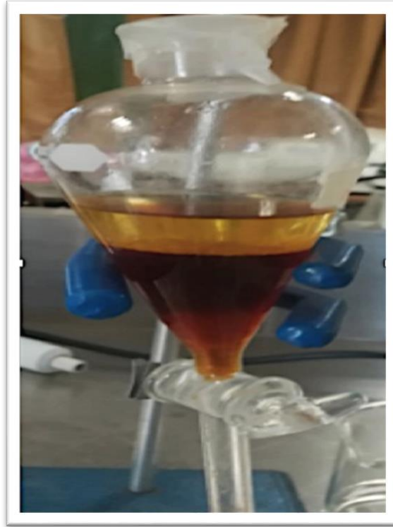
Figura No. 9. Separación de saponinas y fenoles en embudo de separación de fases
