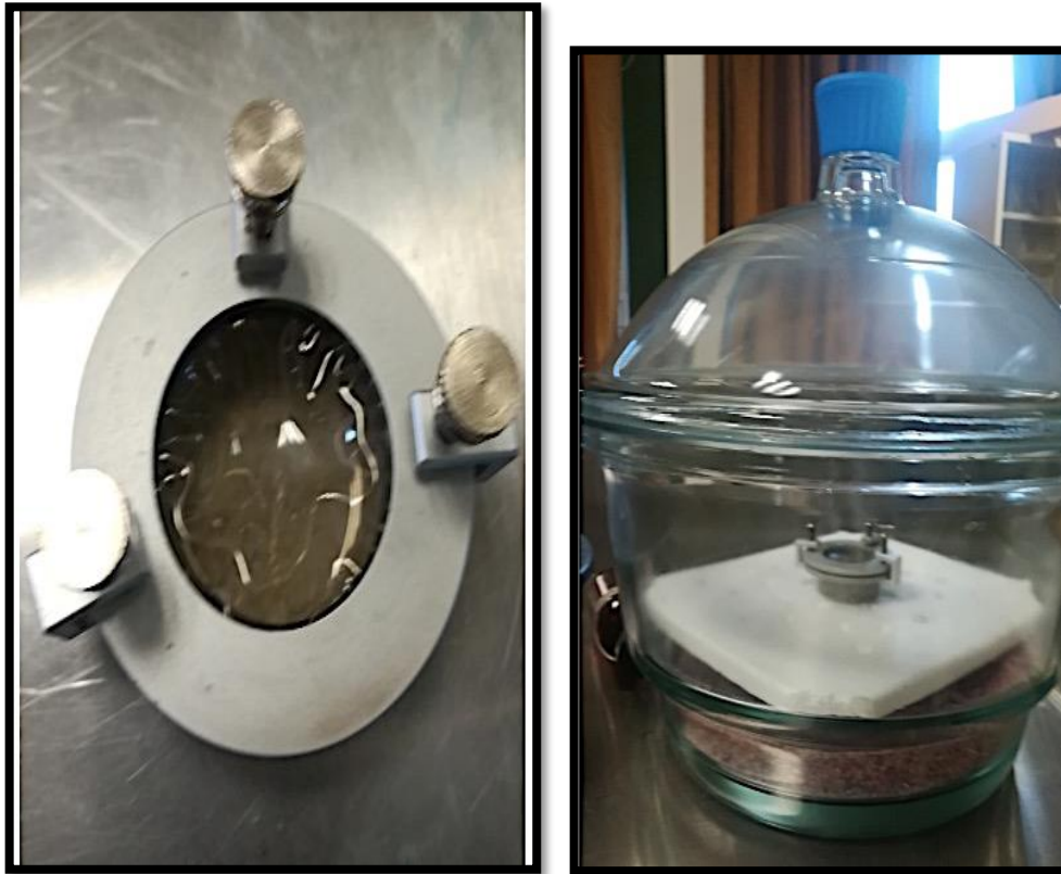
Figura No. 16. Copas de aluminio para medir permeabilidad al vapor de agua
