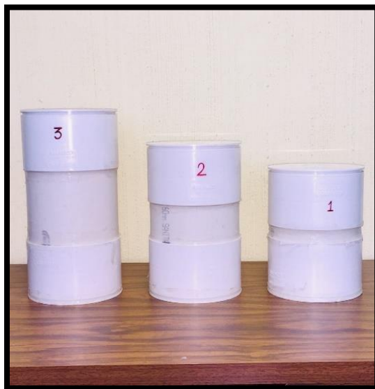
Ilustración 6. Cilindros de policloruro de vinilo (PVC). Cilindro 1 de 22 cm de altura, cilindro 2 de 26 cm de altura, cilindro 3 de 32 cm de altura marcados con el número correspondiente en color rojo.
