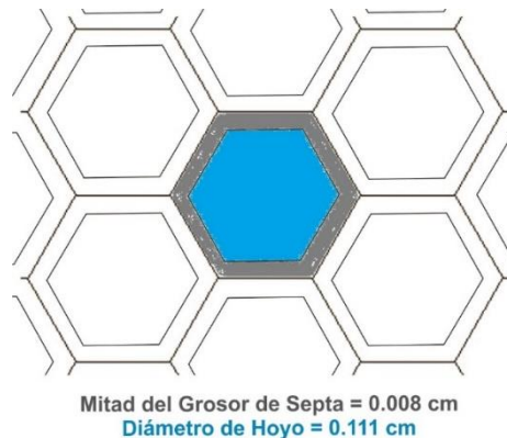
Ilustración 11. Disposición de los hexágonos en el colimador LEHR utilizado en el experimento. Es posible observar en la imagen de que los fotones, a pesar de que llegan perpendicularmente al colimador, pueden colisionar con el grosor de la septa.
