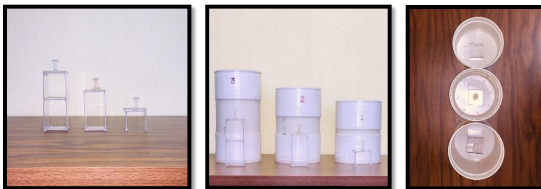
Ilustración 7. Soportes de acrílico para los viales que contendrán el material radiactivo. Soporte para vial del cilindro 1 de 7 cm de altura, soporte para vial del cilindro 2 de 13 cm de altura y soporte para vial del cilindro 3 de 17 cm de altura.
