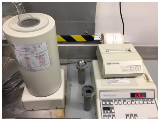
Ilustración 27. Activímetro Biodex Medical Systems, marca ATOMLAB 100 plus del área de medicina nuclear del Centro Oncológico Estatal del ISSEMyM.
