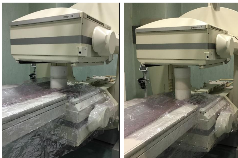
Ilustración 9. Los 3 cilindros se colocaron a 3 centímetros de distancia verticalmente de los detectores 1 y 2 con respecto a sus tapas superior e inferior.
