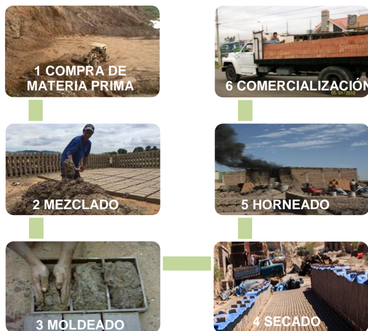
Esquema 4: Etapas del proceso artesanal de producción de ladrillos en San Bartolomé
