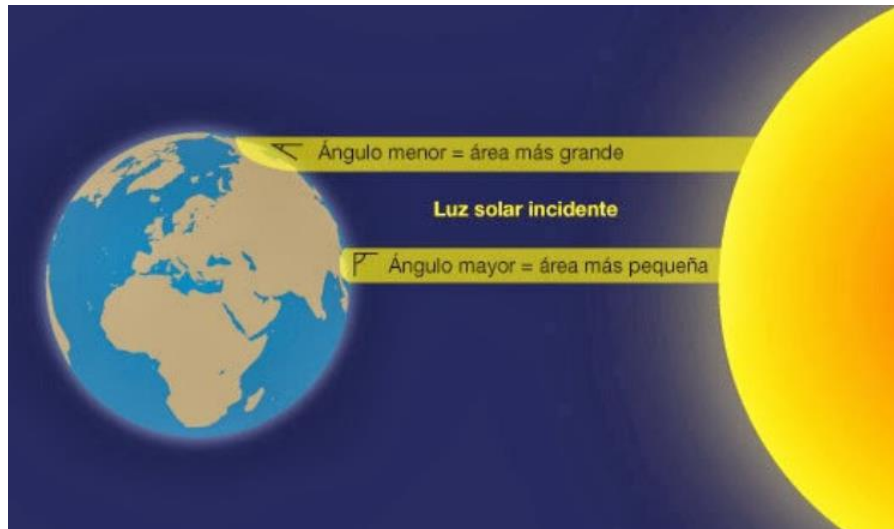
Figura 1.2 Incidencia de los rayos solares sobre la Tierra.
