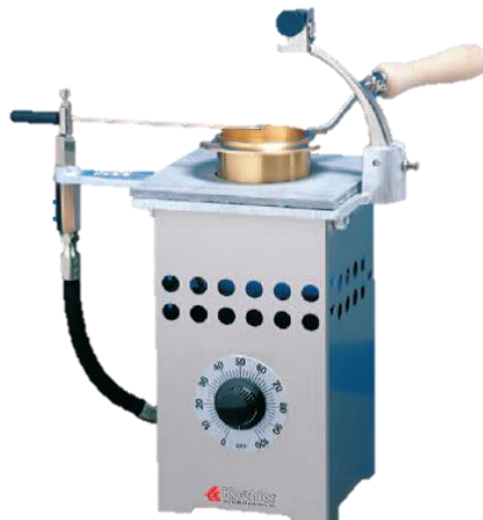
Figura 20. Parrilla eléctrica para la aplicación de calor.
