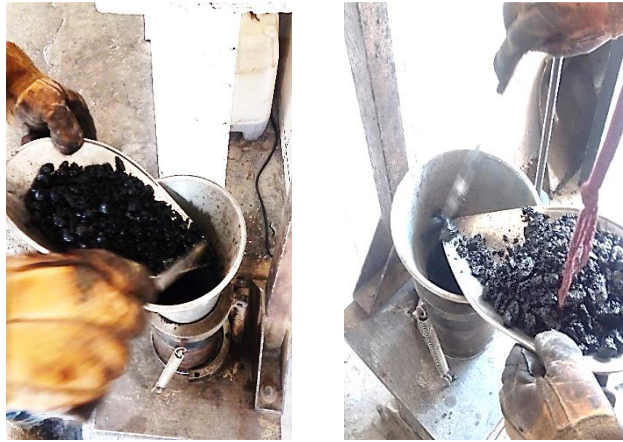
Figura 76. Colocación del material en los moldes
