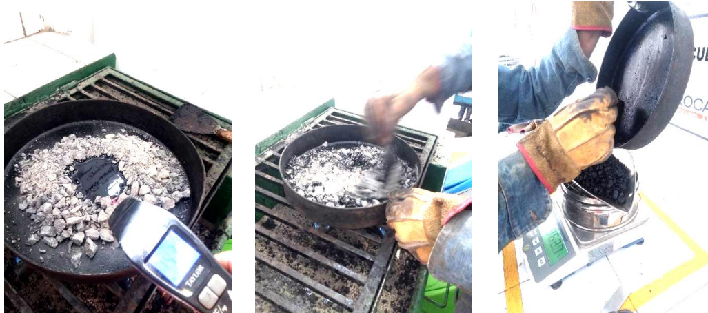
Figura 74. Mezclado del asfalto con el material pétreo
