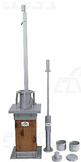
Figura 70. Equipo de compactación
