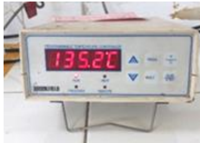
Figura 16. Controlador de temperatura para cámara térmica
