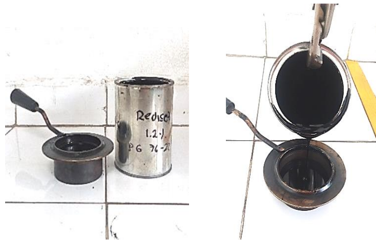
Figura 22. Copa Cleveland con asfalto
