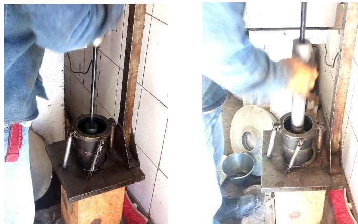
Figura 77. Compactación del material
