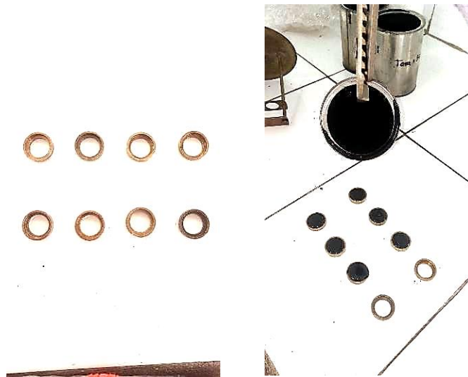
Figura 42. Anillos que contendrán el asfalto
