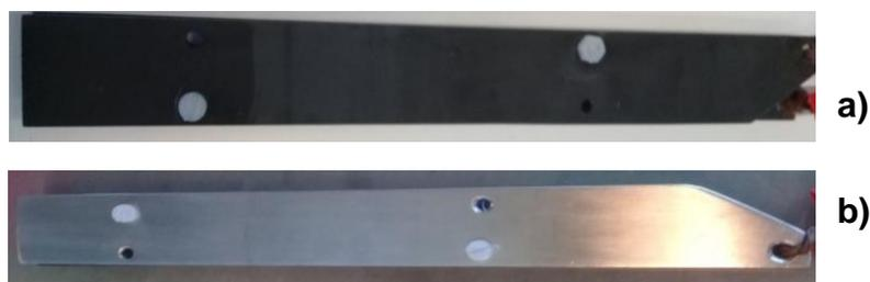
Figura 5. Electrodo utilizados en el tratamiento electroquímico por lotes. a) Ánodo de DDB y b) cátodo de acero inoxidable
