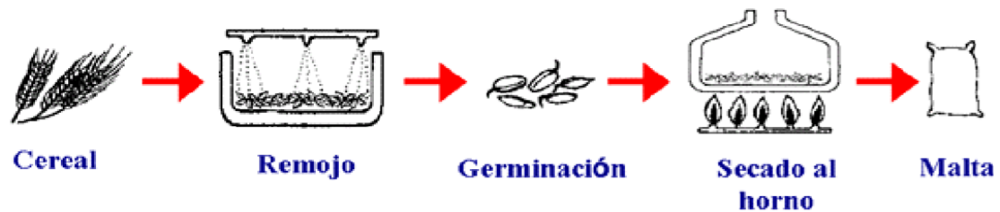
Figura No. 6 Proceso de malteado de cebada.
