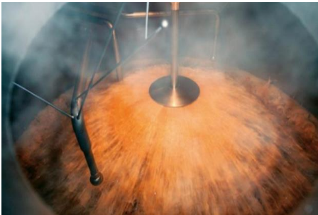
Figura No. 21 Aspersion del mosto sobre el lecho de granos.
