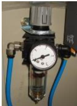
Fig. 3.28 Válvula de control de presión de entrada del aire comprimido de la cuba térmica
