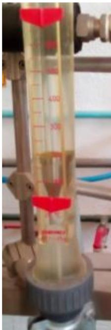
Fig. 3.70 Medidor de flujo
