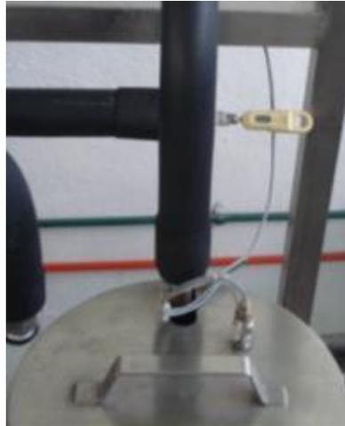
Fig. 3.58 Termómetro bimetálico portátil a la salida del serpentín interno
