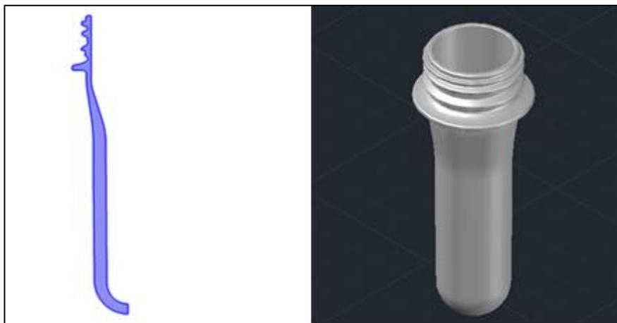
Figura 6.2. Geometría utilizada para la simulación de la preforma 1.
