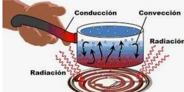
Figura 5.3. Representación de las formas de transferencia de calor
