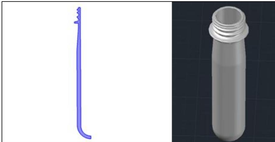
Figura 6.10. Geometría utilizada para la simulación de la preforma 1.
