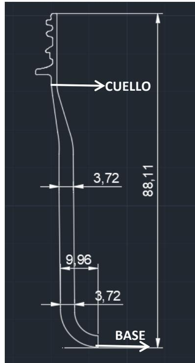
Figura 6.1. Corte transversal de la preforma 1 con algunas medidas en milímetros.
