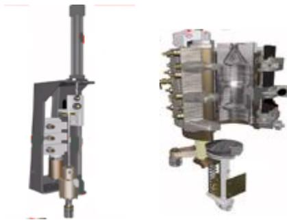
Figura 4.5. Imagen de un molde con la barra de estirado en la unidad de soplado.
