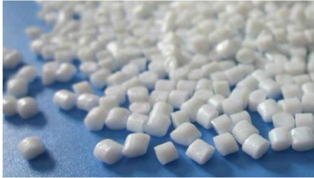
Figura 2.7. Pellets cristalizados de resina PET
