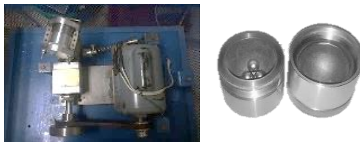
Figura 7. Sistema de molienda mecánica y contenedor, así como los medios de molienda [65].
