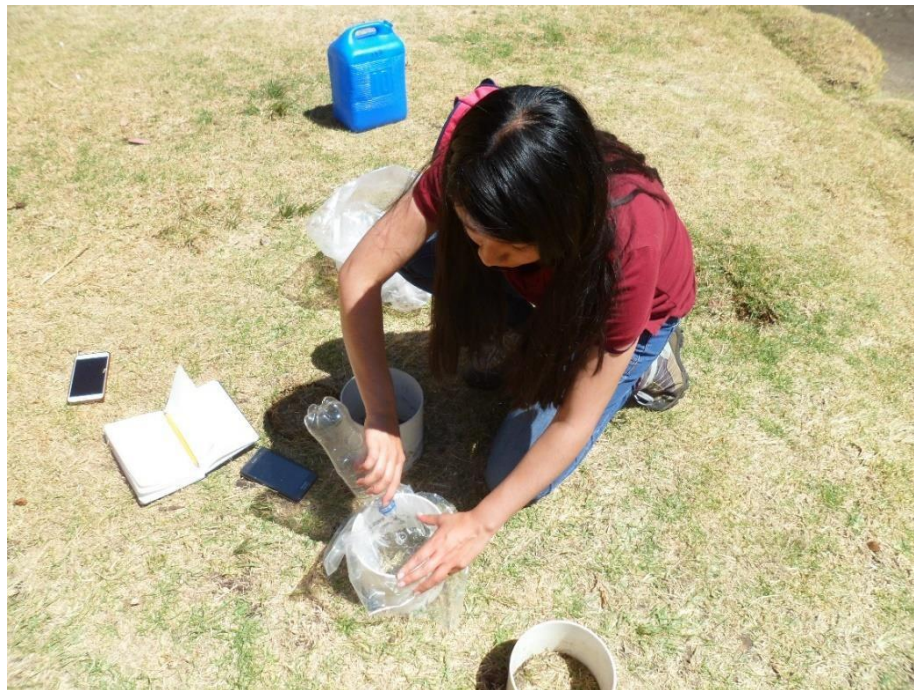
Foto 2: Incorporación de agua en los cilindros de PVC
