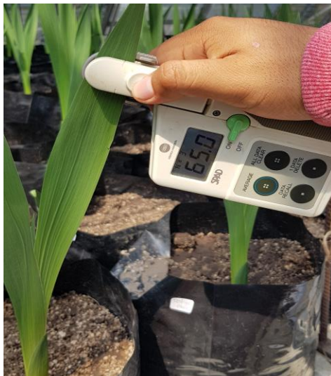
Figura 9. Medición de verdor en hoja con spad.
