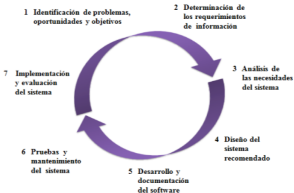
Figura 2. Ciclo de Vida del Desarrollo de Sistemas, donde se puede observar que varias actividades pueden realizarse simultáneamente y ser repetidas. Fuente. (Kendall, 1996).
