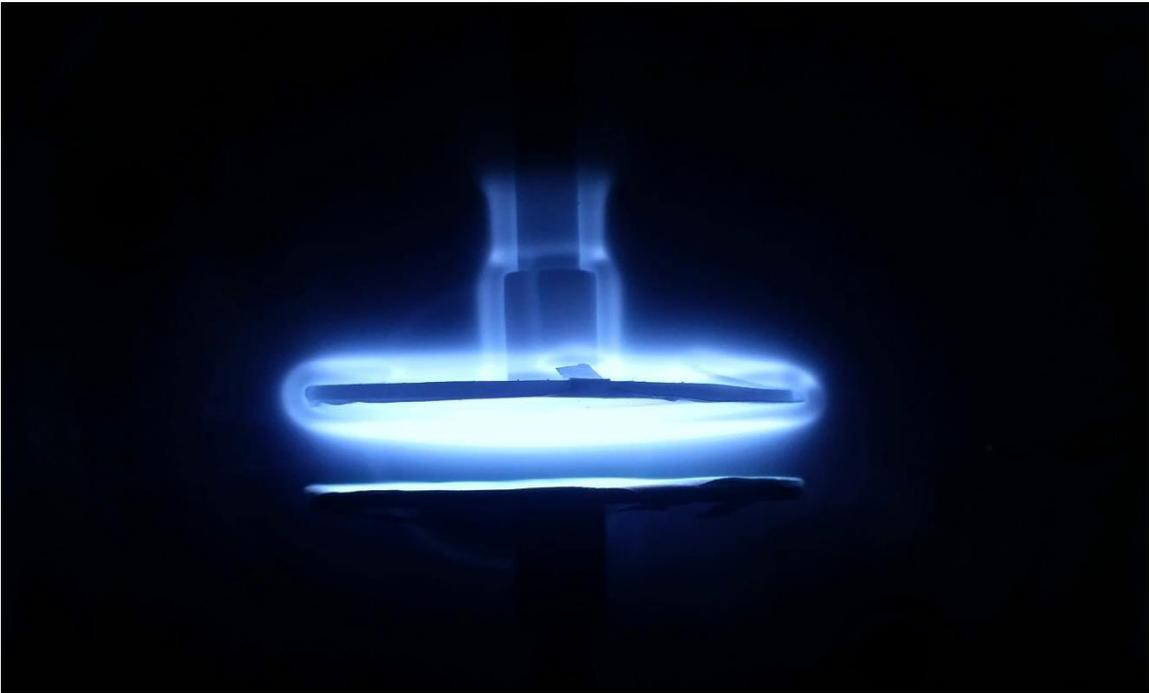
*Fotografía de un plasma generado a partir de etanol con dos electrodos de cobre*
