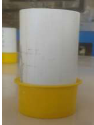
Figura 1.12 Molde para hacer probetas de concreto. Fuente: González Neri, 2015
