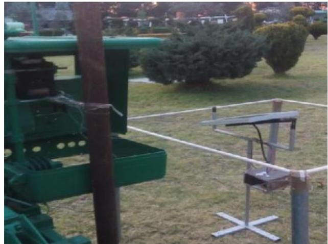
Figura 8. Colocación del sensor con la alimentación de energía fotovoltaica. Fuente: C.A. de Ingeniería Tecnológica
