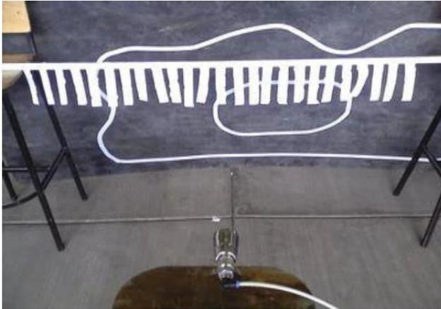
Figura 10. Caracterización del difusor. Fuente: C.A. de Ingeniería Tecnológica
