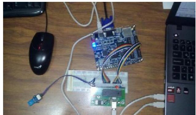
Figura 5. Sistema embebido para registro de temperatura y Humedad. Fuente: C.A. de Ingeniería Tecnológica
