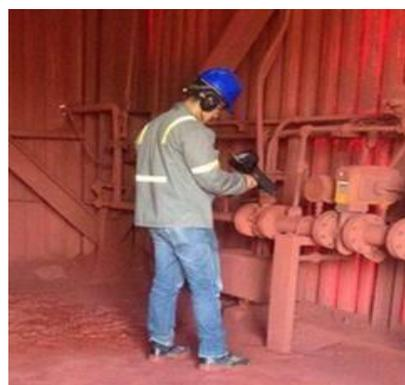
Fig. 1 Detección de fugas en campo
