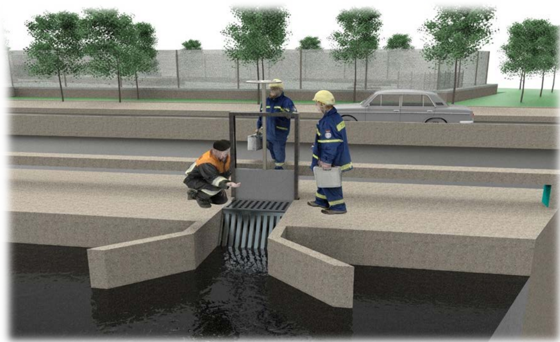
Figura 6.3 Rejilla de desbaste manual
