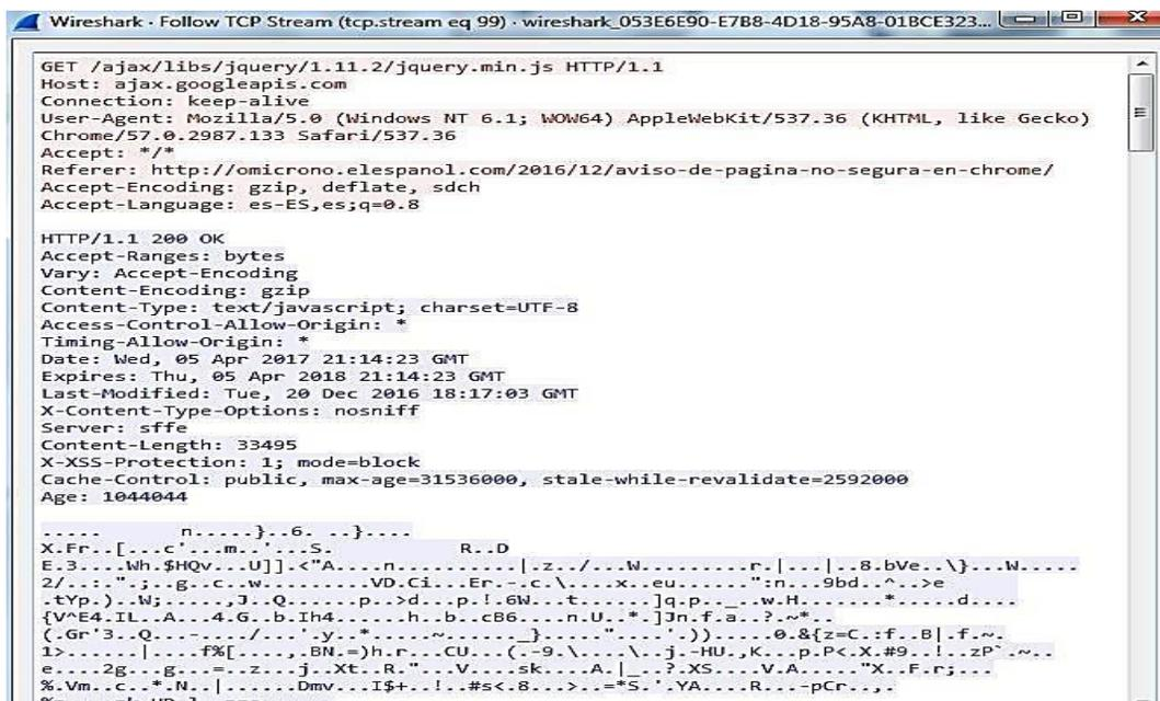
Figura 10. Descripción de paquete TCP conexión no segura http (Propio, 2017)
