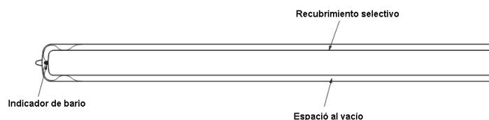
Figura 60. Colector de tubo evacuado tipo-Dewar todo de vidrio.
