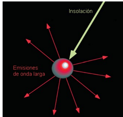
Figura 8. El proceso de absorción de la radiación incidente sobre partículas, y emisión de radiación térmica. Tomado de http://www.physicalgeography.net/fundamentals/7f.html .
