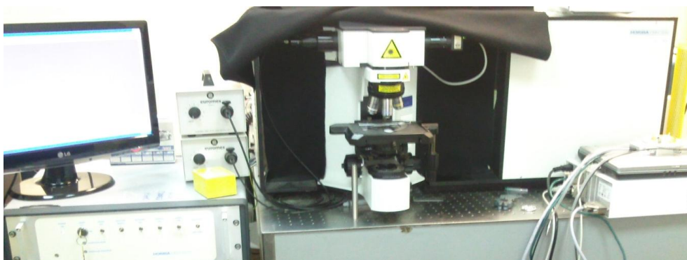
Figura 2.6 Equipo microRaman (LabRam HR 800 de Jobin Ivon Horiba) de alta resolución empleado en este trabajo.
