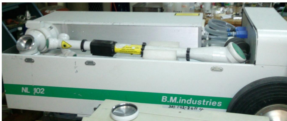
Figura 2.2 Fotografía del láser Nd:YAG empleado en este trabajo.
