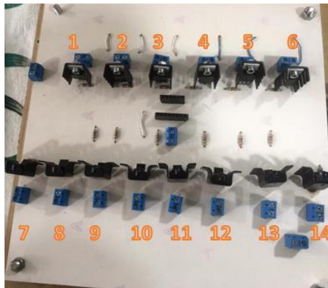
Figura 33. Tarjeta de potencia con componentes eléctricos soldados.
