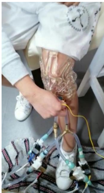
Figura 44. Aplicación de terapia de contraste en rodilla para la evaluación de la temperatura en la compresa.
