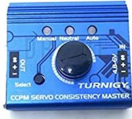
Imagen 45 Regulador de velocidad Servo tester ( Turnigy, USA ) (78).
