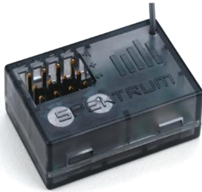
Imagen 41 Receptor de señal radio control Spektrum SR3500 (Spektrum, USA), recibe la señal vía remota y la transfiere al ESC para regular la velocidad de rotación de los IP (74).
