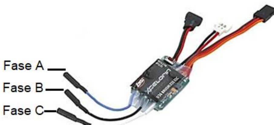
Imagen 39 ESC comercial LOSB9530 1/36th Xcelorin brushless (Losi, USA) (72). Las 3 fases estarían directamente conectadas a las bobinas que corresponde a la Imagen 22.
