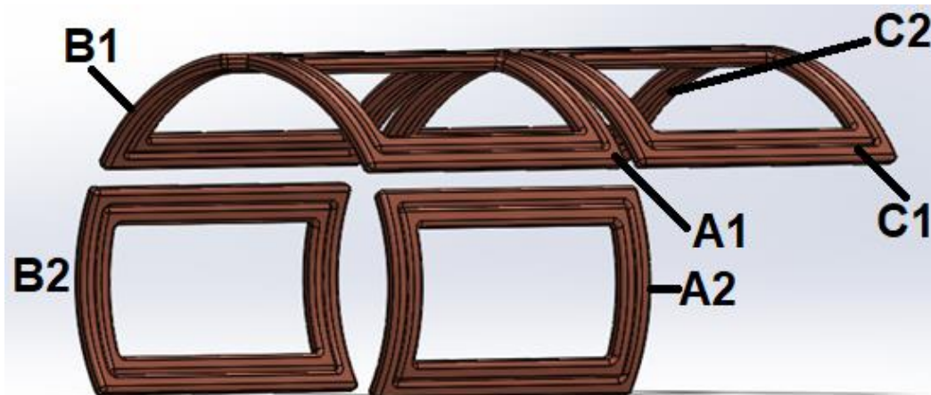
Imagen 23 Configuración de bobinas en el sistema RAVIP (en esta imagen únicamente se pretende representar gráficamente la posición de las bobinas en el dispositivo, por lo que no se observa una conexión entre cada una, sin embargo, el arreglo deberá corresponder al mostrado en la Imagen 22).
