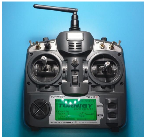
Imagen 42 Control remoto CCPM Turnigy 9X (Turnigy, USA) emisor de la señal (75).
