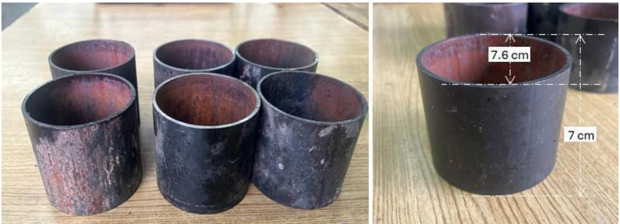
Figura 21. Moldes cilíndricos de acero, que son (moldes permanentes) para formar los lingotes de aluminio.
