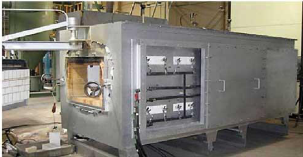
Figura 10. Vista esquemática de un Horno industrial de Resistencias fabricado por la industria Tokai Konetsu Kogyo, Co., Ltd. (Interempresas, 2024).
