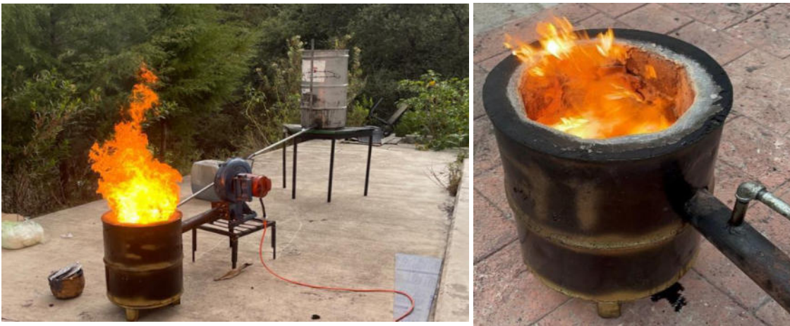
Figura 26. Puesto en marcha de un horno de crisol removible para la fusión del aluminio.
