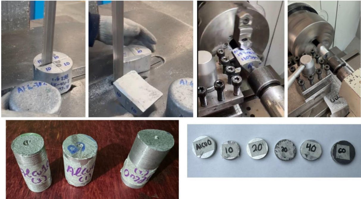
Figura 30. Corte y maquinado de los lingotes de Al y Al-Cu, fundidos en un horno de crisol removible.
