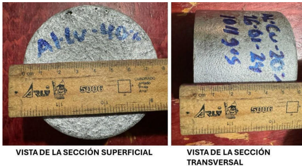
Figura 29. Forma y dimensiones de los lingotes de Al y Al-Cu, fundidas en un horno de crisol removible.
