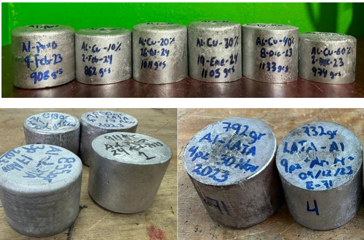
Figura 28. Apariencia de los lingotes de aluminio- Al y Al-Cu obtenidos por fusión.
