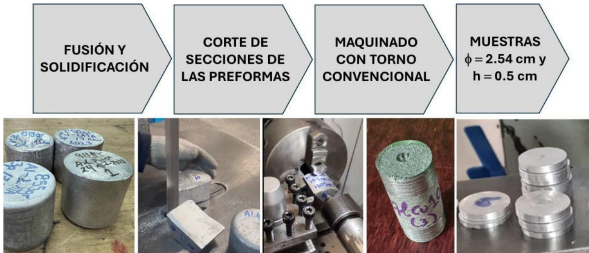
Figura 22. Fusión y solidificación de lingotes fundidos de aluminio. Procesamiento mecánico de los lingotes de aluminio para la extracción de muestras representativas para su estudio de caracterización de propiedades.
