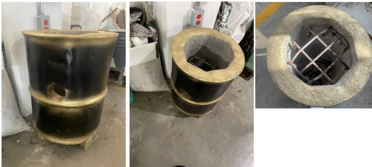
Figura 25. Ilustración del horno de crisol removible terminado, vista lateral y vista superior.
