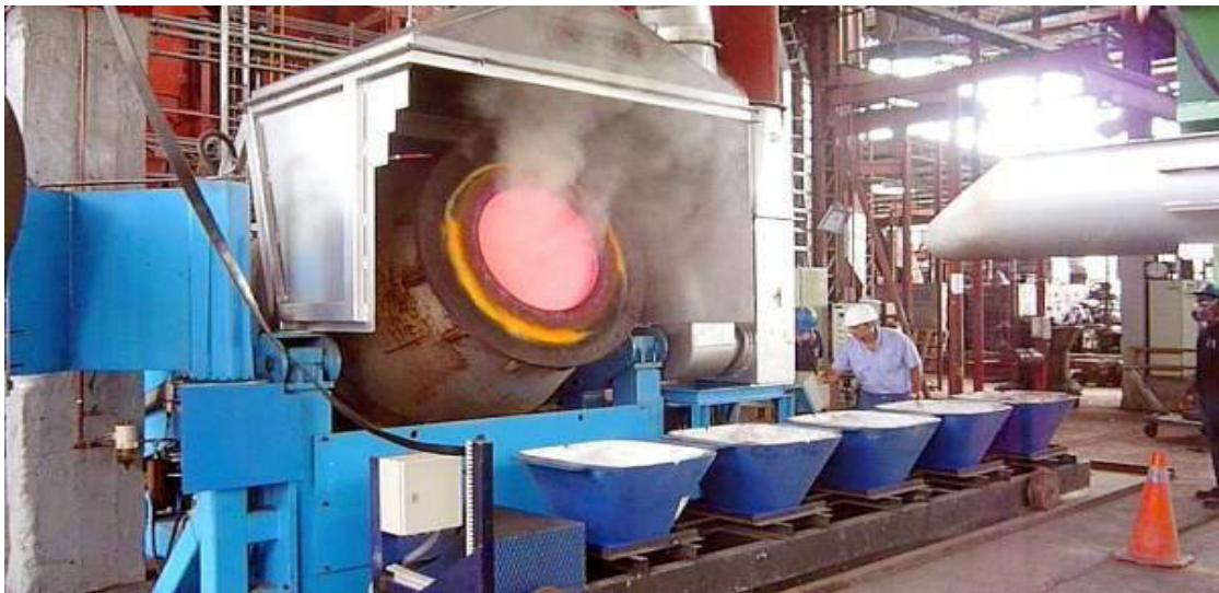
Figura 7. Ilustración representativa de un horno rotativo muy usado en la industria (Hormesa, 2019).
