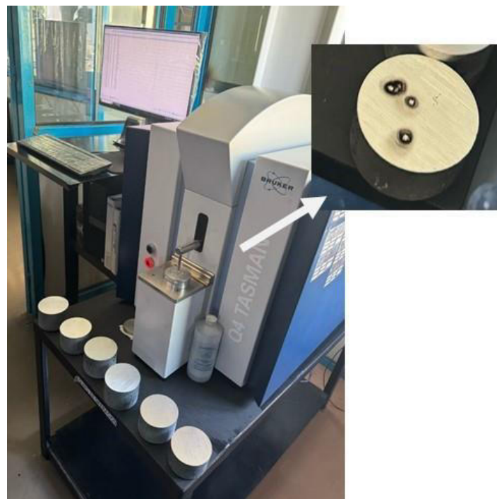
Figura 31. Ilustración de un espectrómetro de Emisión óptica por Chispa, modelo Q4 TASMAR para determinar la composición química elemental en metales.
