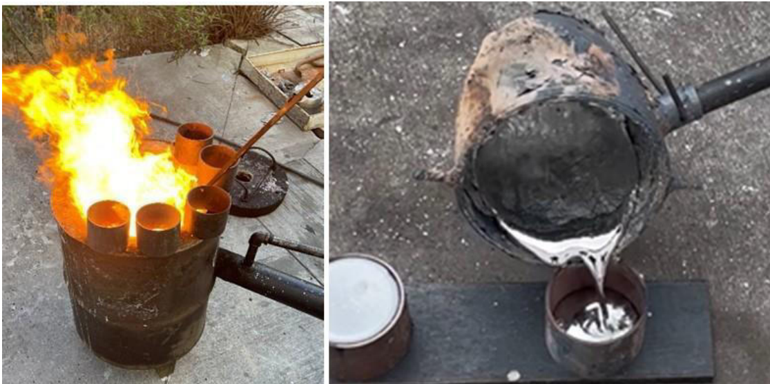
Figura 27. Proceso de fusión del aluminio, y de la aleación Al-Cu, chatarra fundida en un horno de crisol removible, visión del colado en moldes permanentes de acero.
