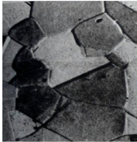
Figura 5. Microestructura típica de la Austenita (Fe- \gamma ) (Avner, 1988).
